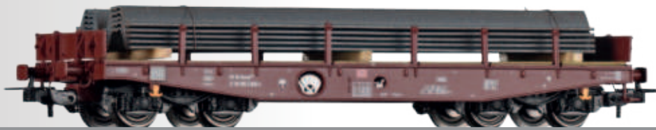
Schwerlastwagen Rmms 662 der DB AG, beladen mit Spundwänden Flat car Rmms 662 of the DB AG with load
