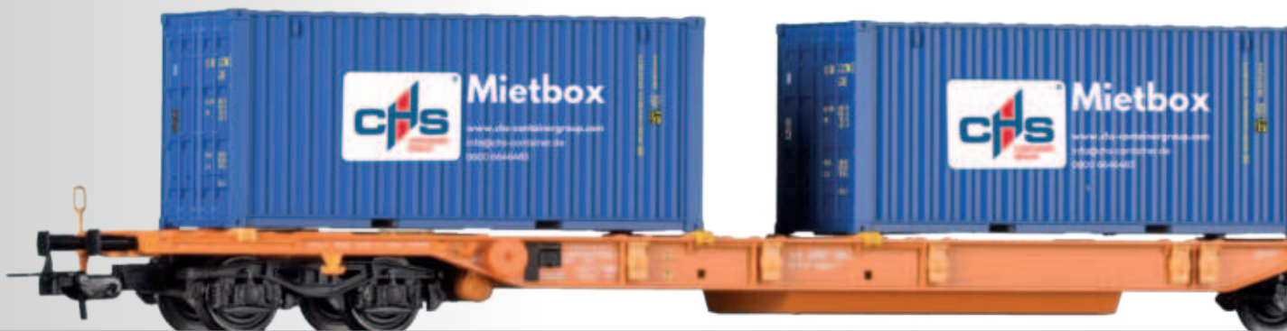
FORMNEUHEIT: Doppeltragwagen Sdggmrs 744 der DB AG, beladen mit vier Containern „CHS Container Handel GmbH“ NEW: Container Car Sdggmrs 744 of the DB AG with four container “CHS Container Handel GmbH”
