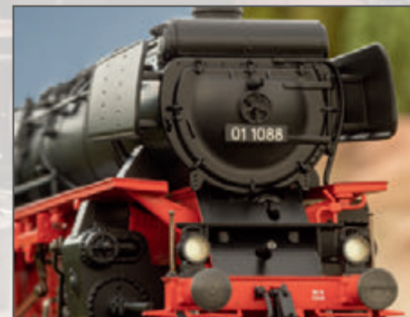
Früher verdeckte die Stromlinienverkleidung den quer eingebauten Knorr-Oberflächenvorwärmer sowie die abgeflachte Rauchkammertür.
